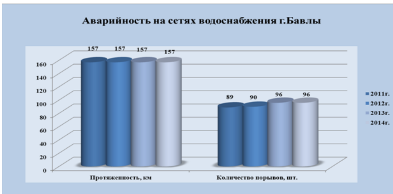
Рис.31 Аварийность на сетях водоснабжения г. Бавлы
