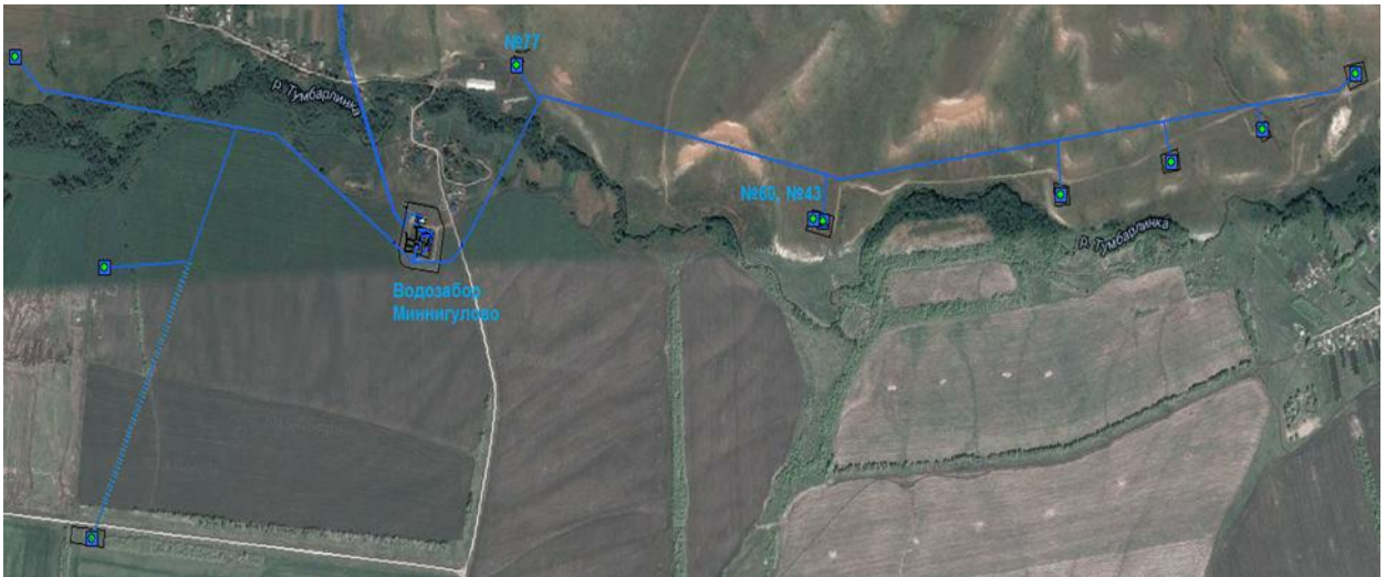
Рис.6 Подача воды с водозабора «Миннигулово»
