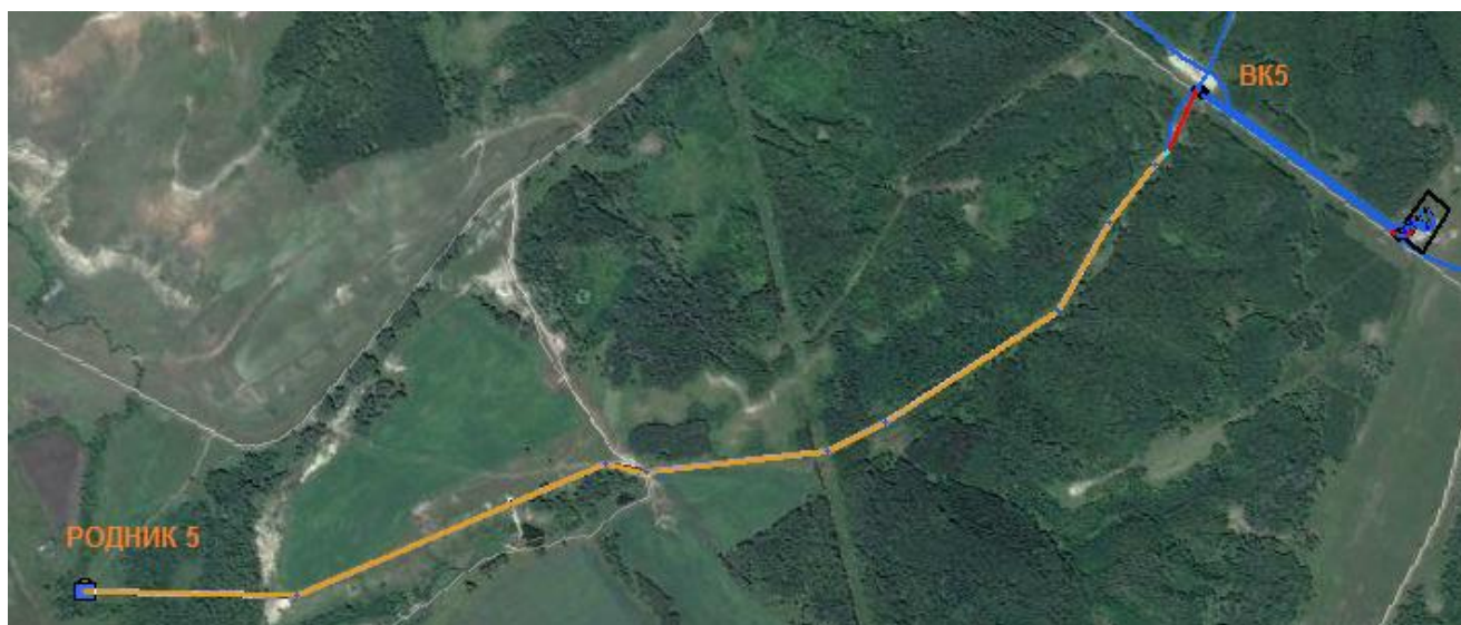
Рис.33 Напорный трубопровод водозабора «Родник 5»
